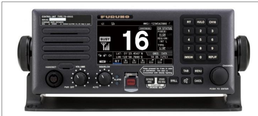
Figura 28: Ejemplo de radioteléfono semi-dúplex Furuno FM-8900S, extraído de [31]
