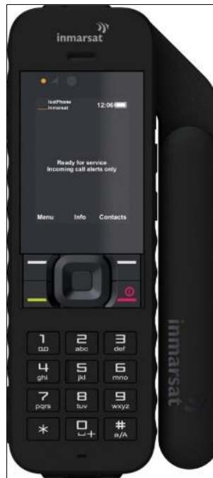
Figura 31: Ejemplo de teléfono satélite Inmarsat IsatPhone 2, extraído de [34]
