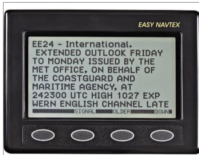
Figura 6: Ejemplo de receptor NASA Easy NAVTEX, extraído de [6]
