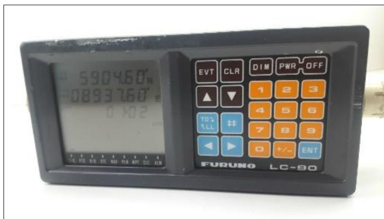
Figura 1: Ejemplo de receptor LORAN-C Furuno, extraído de [1]
