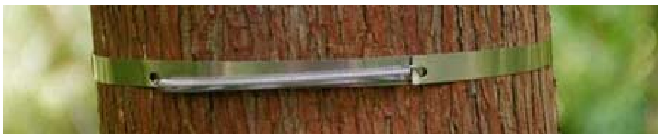
FIGURA 1: Dendrômetro com mola espiral, leitura a olho nú, “fabricação caseira”.
