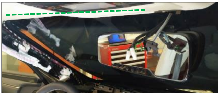
Recorrido del cable del módulo tarifario
