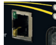
Ethernet port (Modbus TCP) Web master mode
