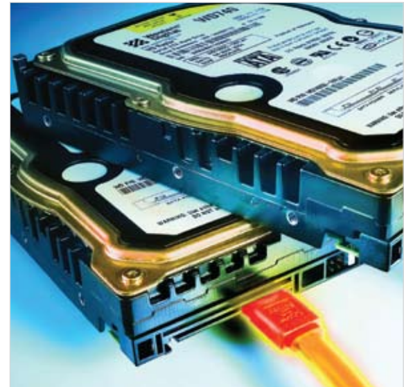
Araçlar RAID Level 0 yapılandırması için iki tane sabit disk yeterli.
