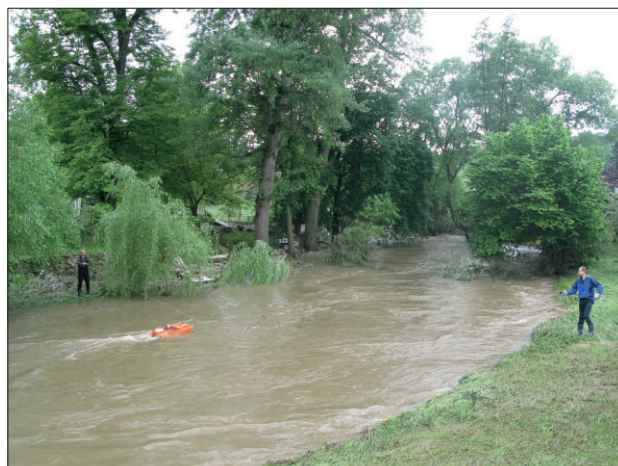
Obr. 6 Měření průtoku přístrojem ADCP – Rio Grande v blízkosti stanice Radč – Mastník, 4. 6. 2013 14:00 UTC, Q_{měř} = 41,5 \text{ m}^3 \cdot \text{s}^{-1} , Q_{kulm} = 103 \text{ m}^3 \cdot \text{s}^{-1} , přemístování měřícího člunu metodou přetahování lana.
