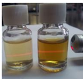
Figura 1. Solución de nanopartículas de plata obtenidas utilizando extracto de epazote y té verde.
