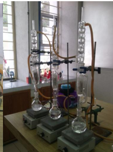
Figura 2. Semillas trozadas de Persea americana y partes aéreas de Ruta graveolens sometidas a reflujo.
