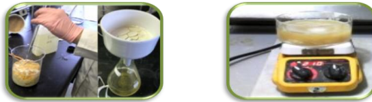
Figura 2: Precipitación, filtrado y reacción de la quitina
