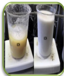
Fig. 7: Desacetilización de la quitina con hidróxido de potasio y sodio al 70% y obtención de quitosano
