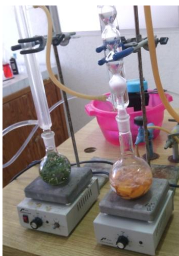
Figura 1. Semillas trozadas de Persea americana sometidas a Sistema Soxhlet con hexano como disolvente.
