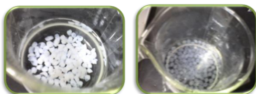
Figura 8a formación de perlas de quitosano con glutaraldehído y 8b sin glutaraldehído
