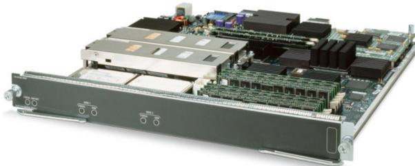
Le Module de Service Cache de la famille Cisco MDS 9000 comprend deux nœuds de traitement haute performance pilotés par le logiciel de stockage IBM TotalStorage SAN Volume Controller (SVC) pour Cisco MDS 9000, afin de déployer des services de réplication et des fonctions de virtualisation au cœur même du Réseau de Stockage.
