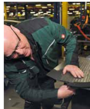
„Die beschichteten Verschleißteile im Gutfluss leisten ganze Arbeit“, weiß Andreas Wippenbeck zu berichten: „Wir bestellen diese immer ab Werk. In den 3.000 bis 4.000 h, die die Maschinen bei uns im Einsatz sind, mussten wir nicht einmal ein Premiumline Verschleißteil tauschen.“ Auf diesem Bild verschraubt er gerade den langen Trommelboden.
