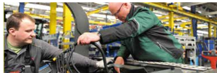
An der 2. Station erfolgt die Verlegung des Hauptkabelbaumes. Andreas Wippenbeck hilft Mitarbeiter Daniel Bartsch bei der Montage. Hierbei wird besonders darauf geachtet, dass die Kabel nirgends am Rahmen scheuern. Nichts ist schlimmer, als ein Elektronikausfall bei einer so wichtigen Erntemaschine wie einem Häcksler.
