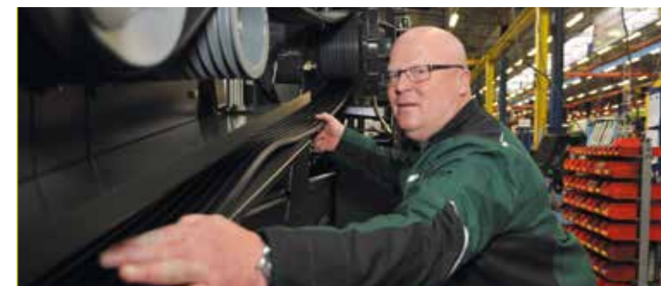
Mit dem Powerband wird die Kraft vom Motor auf die Häckseltrommel übertragen. Hier wird es auf die einzelnen Riemenscheiben und -spanner gelegt. Das ist bei dem 13 m langen Riemen gar nicht so einfach. Andreas Wippenbeck: „Hier in der Montagelinie kommt man aber sehr gut überall ran. Im Vergleich zum Austausch des Powerbandes ist die Erstmontage ein Klacks.“
