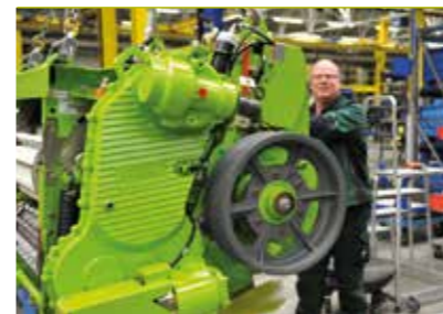
An Station 7 der Montagelinie wird eine wichtige – wenn nicht sogar die wichtigste – Komponente des Häckslers montiert: Das Einzugs- und Trommelgehäuse, das im CLAAS Werk in Bad Saulgau bereits vormontiert wurde, wird vorsichtig von Andreas Wippenbeck mit dem Kran in die Montageposition gefahren.
