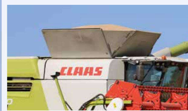
Die Modelle 780 und 770 erhalten ein Korntankvolumen von maximal 13.500 Liter.
