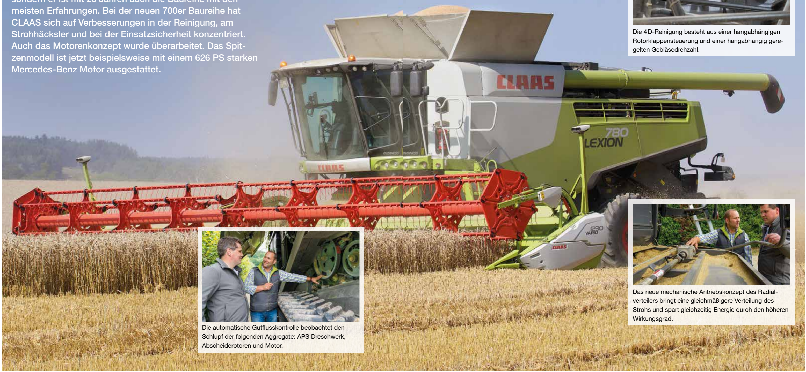
Die Modelle 780 und 770 erhalten ein Korntankvolumen von maximal 13.500 Liter.
