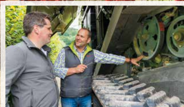
Die automatische Gutflusskontrolle beobachtet den Schlupf der folgenden Aggregate: APS Dreschwerk, Abscheiderotoren und Motor.
