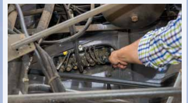
Die 4D-Reinigung besteht aus einer hangabhängigen Rotorklappensteuerung und einer hangabhängig geregelten Gebläsedrehzahl.
