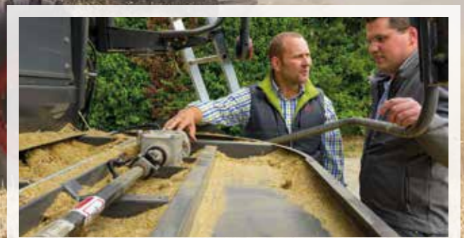
Das neue mechanische Antriebskonzept des Radialverteilers bringt eine gleichmäßigere Verteilung des Strohs und spart gleichzeitig Energie durch den höheren Wirkungsgrad.
