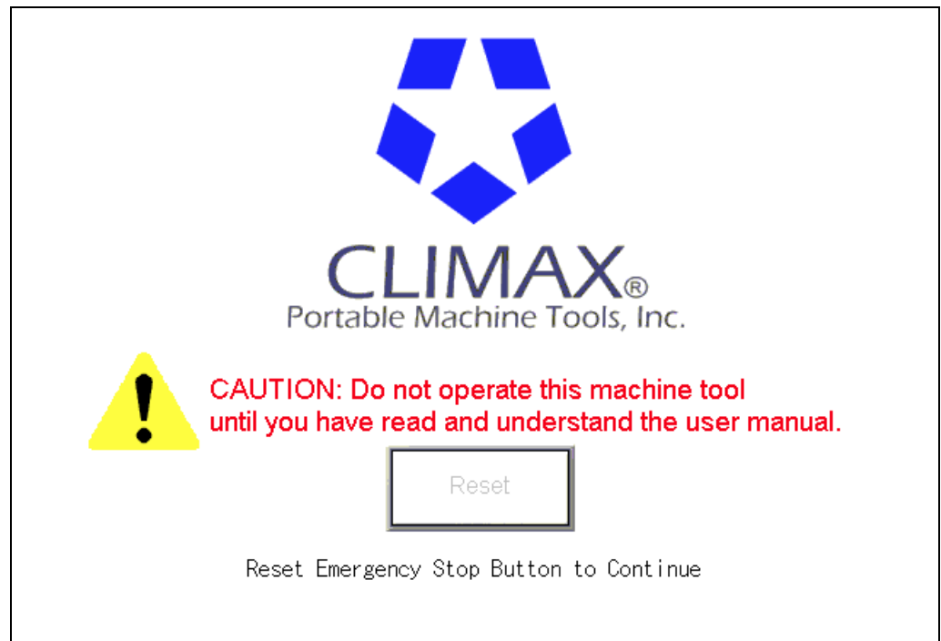
FIGURE 4-14. RÉINITIALISER L'ÉCRAN EN CAS DE BOUTON D'URGENCE ENFONCÉ
