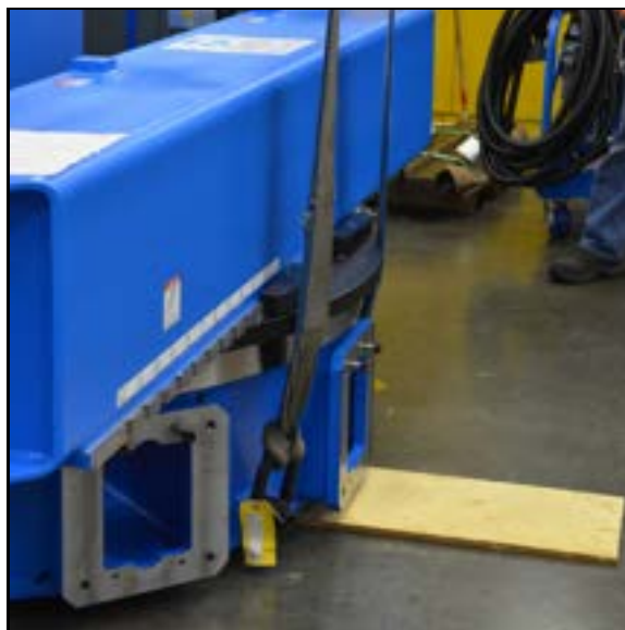
FIGURE 3-28. PLANCHE ET SANGLES POUR L'INVERSION
