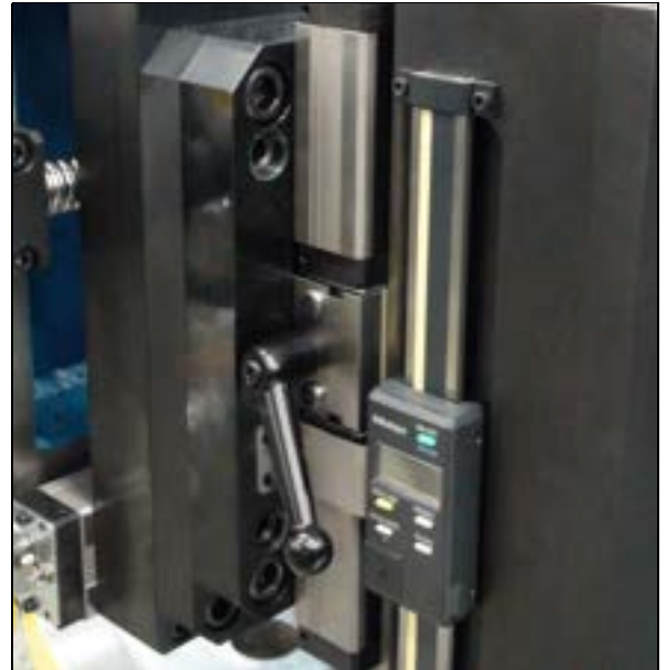
FIGURE 4-1. BLOCAGE DE LA BROCHE ET DRO
