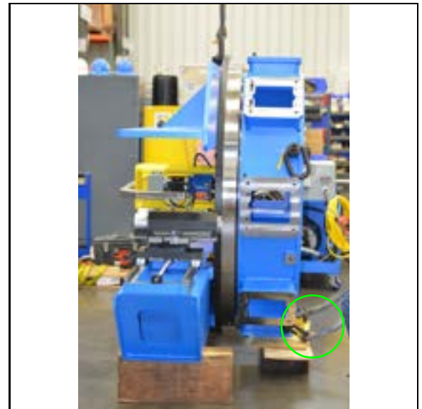
FIGURE 3-30. LA CM6200 VERTICALE SUR LES BLOCS AVEC LES SANGLES RATTACHÉES
