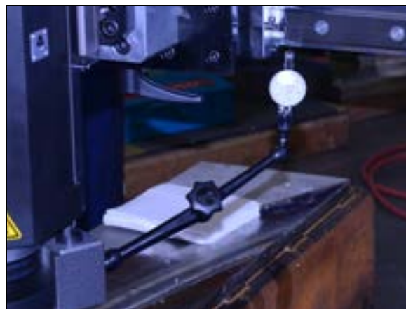
FIGURE 4-4. BROCHE TOURNÉE VERS LA SURFACE DU COULISSEAU
