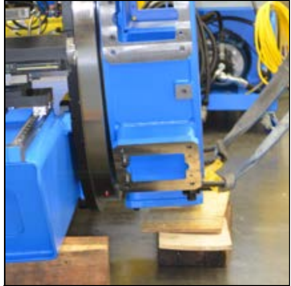
FIGURE 3-31. LEVAGE DE LA CM6200 DES BLOCS
