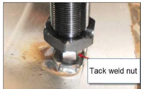
Abbildung 3-22. Befestigung der Außenspannung mit einer Heftschweißmutter
