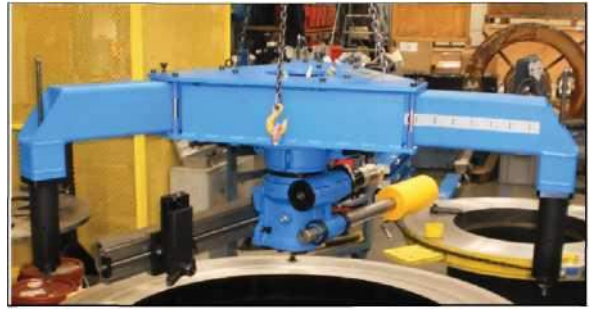
Abbildung 3-19. Anordnung für Außenspannung
