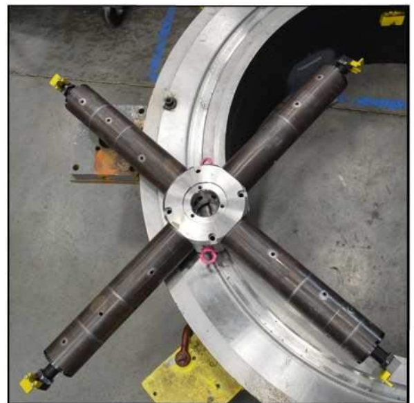
Abbildung 3-3. Montieren Sie die Innenspannung
