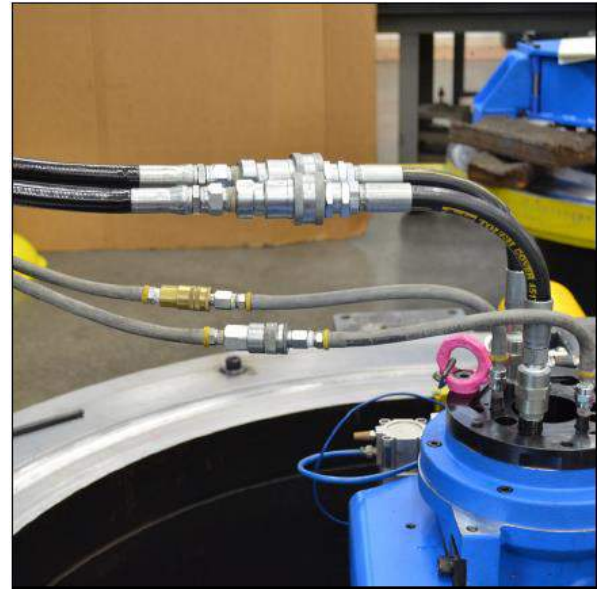
Abbildung 3-8. Verbinden Sie die Schläuche (Hydraulik-Version)
