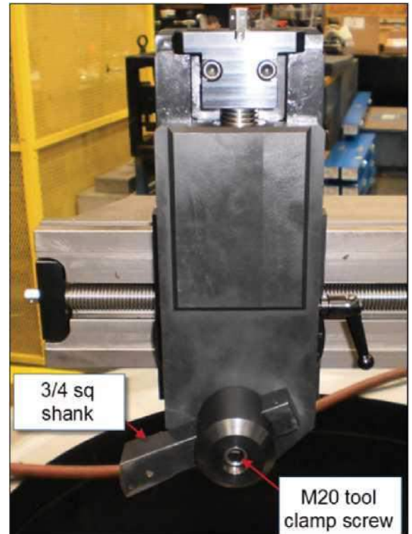
Abbildung 3-30. Detail des Werkzeughalters
