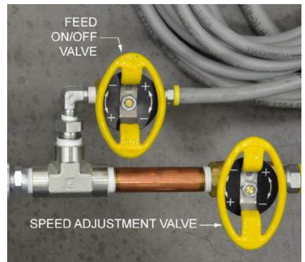
Abbildung 4-2. Ventile an pneumatisch betriebenen Maschinen
