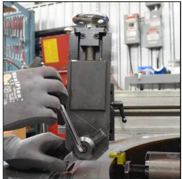
Abbildung 3-7. Installation eines Werkzeugeinsatzes
