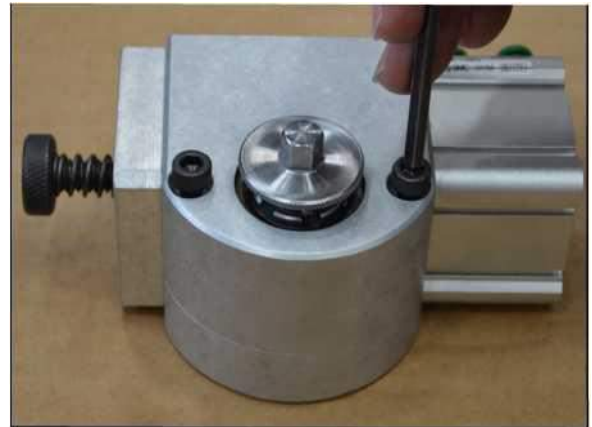
Abbildung 3-38. Ort der Schrauben der Vorschubbox
