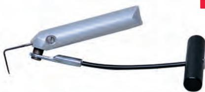
UltraWiz Ziehmesser aus Aluminiumguss mit ergonomischem Griffprofil. Durch die seitliche Klemmschraube kann die Klinge schnell gewechselt und, je nach Bedarf, in unterschiedlichen Positionen fixiert werden. Lieferung inklusive 1 Ziehklinge 25 mm lang.
