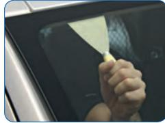
Die Spachtel ist sehr praktisch zum Führen des Drahtes vom Innenraum aus. Dieses Werkzeug ist besonders hilfreich um den Draht über Führungsstifte zu heben bzw. diese von der Scheibe zu lösen.
