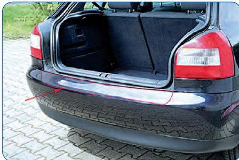
Lackierte Fahrzeugteile wie Kotflügel, Hauben, Stoßfänger oder Außenspiegel sind damit beinahe unsichtbar gegen Steinschlagschäden geschützt.
