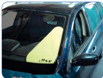
Der Armaturenbrettschutz aus 2 mm starken Kunststoff ist sehr elastisch und passt sich mühelos allen Wölbungen an. Dabei ist er gleichzeitig besonders widerstandsfähig und hart, damit Schneide- und Sägedrähte leicht darüber gleiten können.
