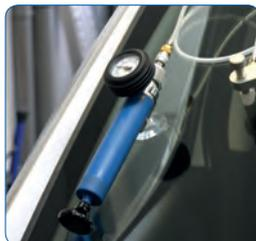
Mit dem Saughalter kann die Druck-/Unterdruckpumpe WSR-150-5 auf der Scheibe oder an anderen glatten Oberflächen befestigt werden. Dies ist z. B. bei der Verbundglas-Reparatur an Nutzfahrzeugen sehr hilfreich.
