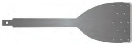
Bei den Express® HydroBlade Klingen wurden auf der dem Glas abgewandten Seite eine Reihe runder Vertiefungen eingestanz. Diese Vertiefungen sind so geformt, dass sie das Schneideschmiermittel in die Kleberaube transportieren. Das Schmiermittel lässt die Klinge mit jedem Hub leichter in die Kleberaube gleiten. Abgesehen vom leichteren Schneidevorgang führt die niedrigere Reibung der Klinge auch zu einem geringeren Batterieverbrauch und reduziert die Vibrationen des Gerätes.
