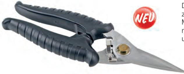
Der handlich geformte Allerschneider ermöglicht durch seine fein gezahnte Klinge das sehr präzise und leichte Schneiden von folgenden Materialien: Gummi, Kunststoffe, Pappe, Papier, Leder, Kabel bis 2,0 mm, Draht bis 2,0 mm, Blech bis 0,8 mm und vieles mehr. Sehr solide und langlebige Konstruktion.
