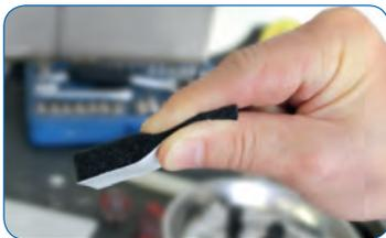
Aufgrund der guten akustischen Eigenschaften (Reduzierung von Vibrationen und niederfrequenten Schwingungen) kann dieses selbstklebende, langsam aufquellende Schaumstoffband auch bei vielen anderen Fahrzeugen sinnvoll zur Geräuschdämmung eingesetzt werden.
