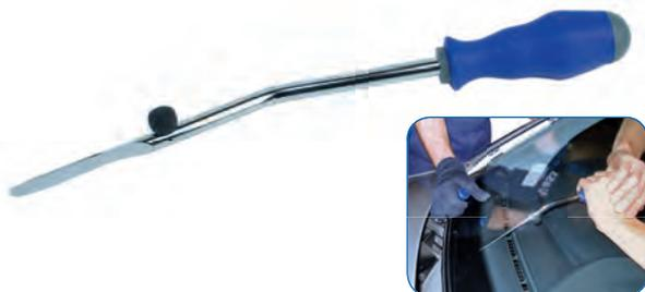
Mit dem Drahtgegenhalter lässt sich der Draht im Fahrzeuginnenraum so führen, dass eine Beschädigung von Armaturenbrett, Verkleidungen und Karosserie vermieden wird. Länge der abgeflachten Spitze: 7 cm, Gesamtlänge des Werkzeugs ca. 34 cm. Rändelschraube mit M4 Gewinde für sichere Befestigung des Drahtes ohne zusätzliches Werkzeug.
