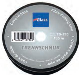
Spezielschnur aus hochfesten, geflochtenen Polyethylen-Fasern. Dank des sehr geringen Durchmessers von nur 0,5 mm kann diese Trennschnur von Hand (mit Zuggriffen TSG oder DGL) gezogen werden. Aber auch mit dem SPIDER kann die Schnur eingesetzt werden um z. B. sehr tief auf dem Karosseriefansch liegende Scheiben auszutrennen. Allerdings ist hier u. U. keine mehrfache Verwendung möglich.
