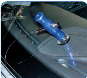
Durch den angebrachten Sauger kann der Zuggriff überall auf der Scheibe und sogar auf lackierten Flächen sicher positioniert werden. So kann man z. B. auf die andere Seite des Fahrzeuges gehen und den Zuggriff bequem wieder aufnehmen. Der Zuggriff kann nirgends mehr anschlagen und der Draht berührt nicht unnötig die Fahrzeuglackierung oder andere empfindliche Oberflächen.
