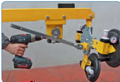
■ **SL-350-ZS1 Schwenkvorrichtung für Scheiben-Lift**
