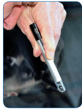
Taschenmikroskop aus Aluminium und Kunststoff mit 25-facher Vergrößerung. Als Hilfsmittel zur Reparatur und Beurteilung von Steinschlagschäden und Glaskratzern.
