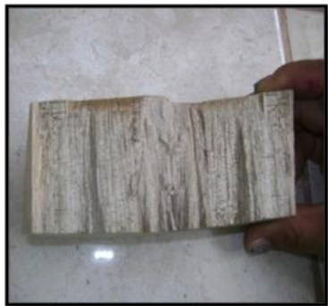
Se hizo un corte a la mitad del cubo siguiendo la dirección de los radios para determinar el grano
