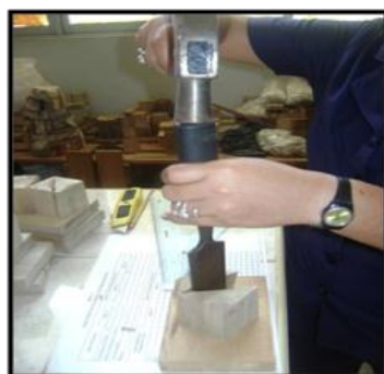
Se hizo un corte a la mitad del cubo siguiendo la dirección de los radios para determinar el grano
