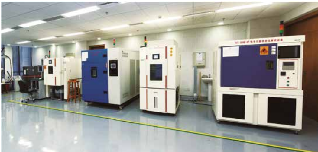
高温振动试验箱、温度冲击试验箱、快速温变湿热试验箱、电子元器件老化测试设备
