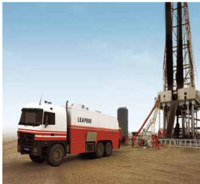
LEAP800测井系统在油气田测井现场
