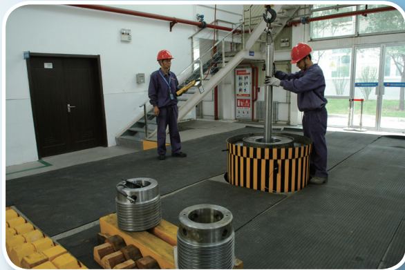
200°C / 170MPa 高温高压实验井
