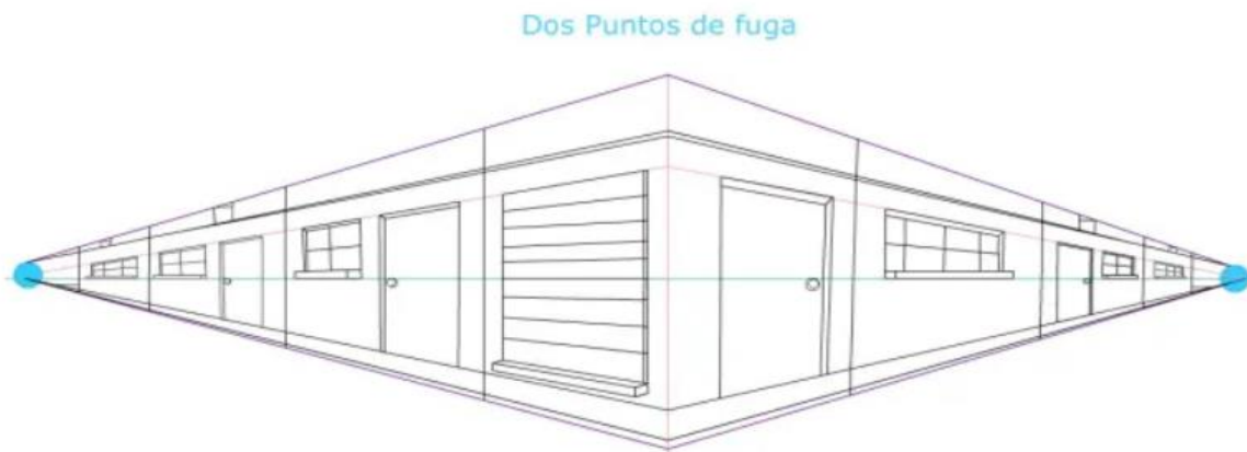
Imagen 2.26. Ejemplo perspectiva con dos puntos de fuga
