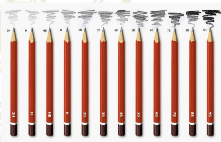
Imagen 1.11. Espesor de la mina de los lápices para dibujo
