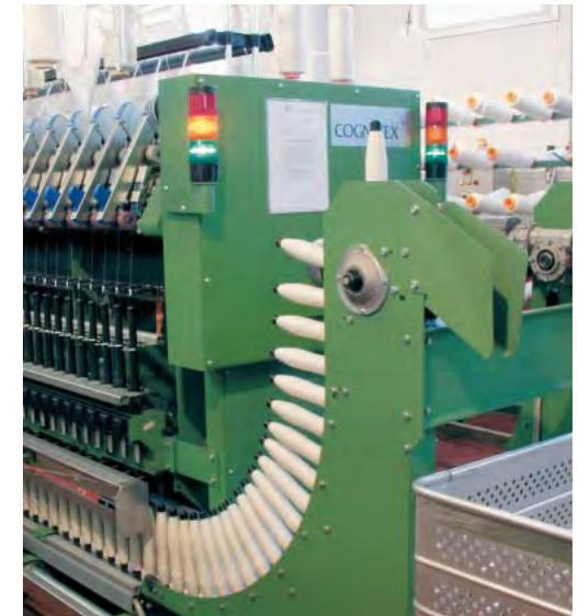
Rampa di scarico spole filatoio monomando
