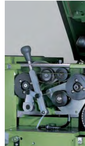
▲ Comando positivo per calandre di accompagnamento Positive drive of the calender rollers
