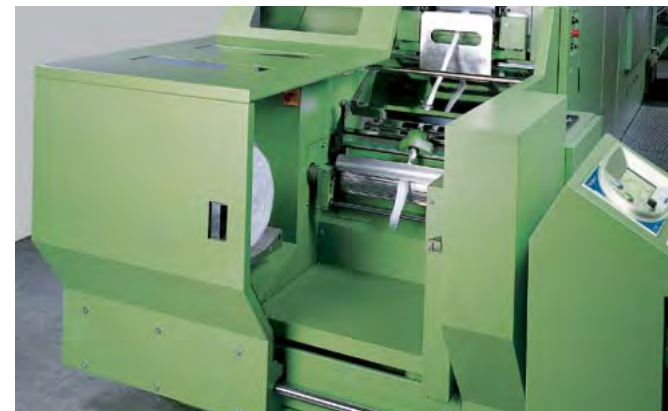
Uscita a bobine: fase di espulsione bobina e riavvio Bobbins carriage: bobbin expulsion and restart phase
