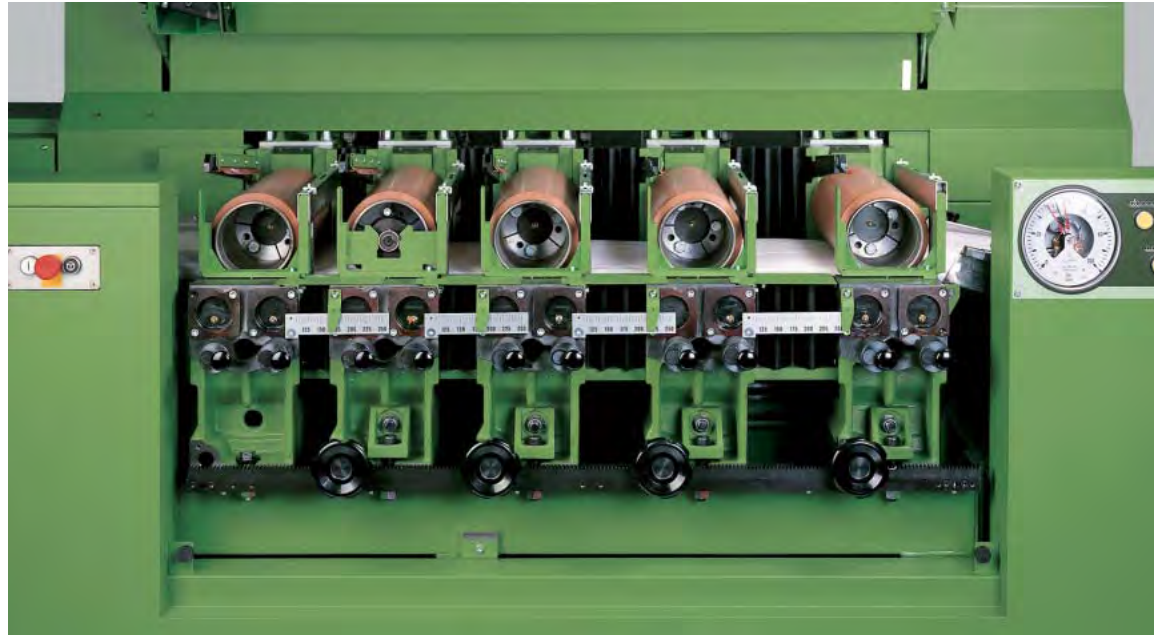
Modulo di prestiro a 5 rulli Roller pre-drafting module
