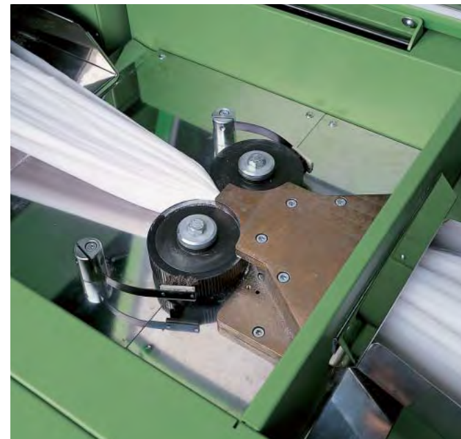
Tastatori autoregolatore Auto-leveller's feelers
