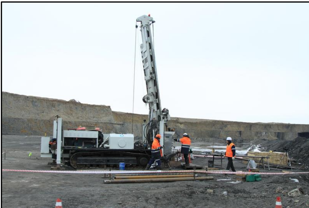
Figura 37. Ejemplo de una máquina de perforación diamantina sobre orugas.
