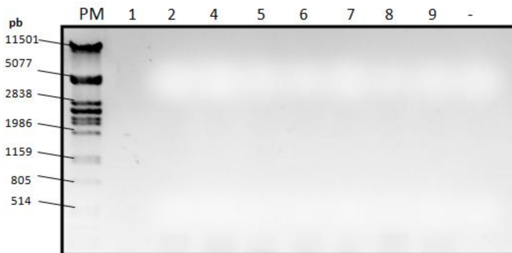
Figura 36 Electroforesis en gel de agarosa 1 % donde se cargaron los 25 \mu L correspondientes a los productos de amplificación por PCR de las colonias crecidas en la reacción de Gateway, utilizando los cebadores forward del TA2 y reverse del TA3.
