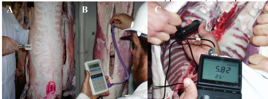
Anexo 9. Determinaciones realizadas en la canal: A) punto GR, B) temperatura y c) pH.
