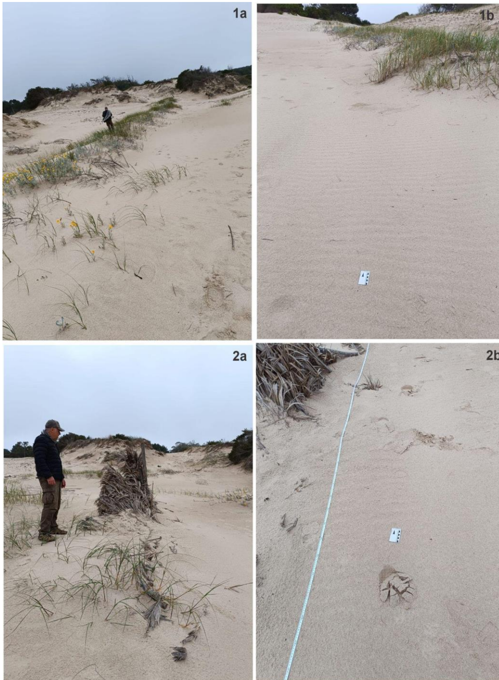
Figura 23. Barreras 1 y 2. 1a: Barrera en donde se muestra vegetación psamófila. 1b: ripples asociados a la barrera 1. Nótese que la dirección del viento indicada por los ripples es casi paralela a la orientación de la barrera. 1c: barrera captora 2 destruida y con poca acumulación de arena. 1d: Dirección de viento de los ripples casi paralela a la barrera 2.
