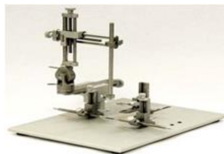
Figura 4. Estereotáxico utilizado para la inyección en la cisterna magna.
