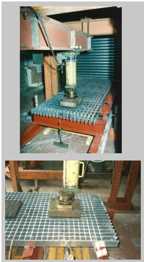
Fig. 4 - Grigliato impalcato primo modello Ponte di Messina
