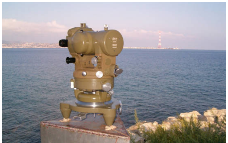
Fig. 7 - Uno degli originari teodoliti di alta precisione utilizzati per la misura dello stretto di Messina
