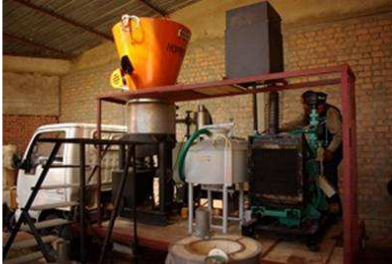
Le plus petit modèle disponible (11kw/h) [petite unité de gazéification de biomasse] posé sur un camion. Et c'est même possible de brancher le camion dessus et le faire avancer avec l'énergie électrique produite!
