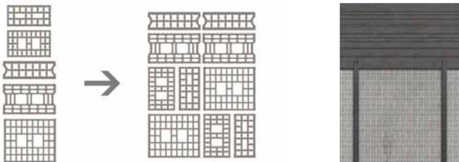
13/14 - Le nuove facciate del forno Hofmann realizzate con manufatti in laterizio ricavati dal catalogo di produzione della fornace. Il tamponamento di facciata lascia filtrare aria e luce
