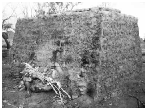
Fig.7) Fornace africana temporanea (a pignone) ancora in uso
