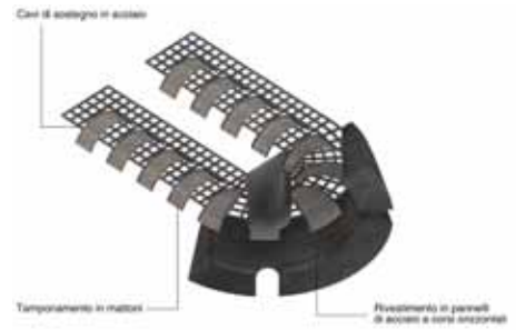
15/16 - La fornace Croce nel parco delle Groane: pianta del forno Hofmann e l'assonometria del nuovo elemento di innesto che va a riprodurre una delle teste "mozzate" del forno.
