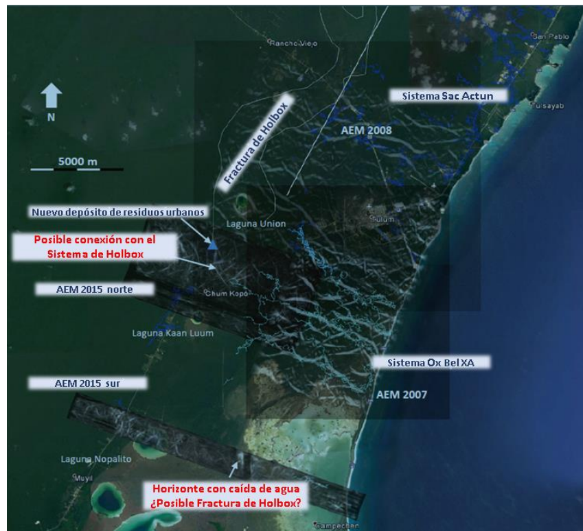
Figura 17. Mapeo de cuevas y ríos subterráneos a partir de sensores aéreos electromagnéticos realizados en 2007, 2008 y 2015. Cabe resaltar que las líneas azules representan los mapeos mediante espeleobuceo (Fuente: Schiller et al. , 2017).
