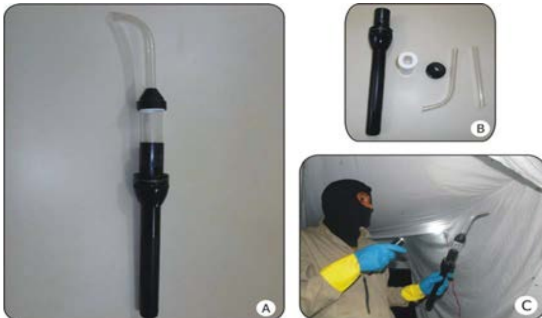
Figura 15. Capturador elétrico “importado”: A = equipamento montado; B = equipamento desmontado; C = equipamento sendo utilizado em coleta de flebotomíneos em armadilha de Shannon. Fotos: Demilson R. Santos.
