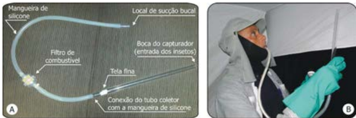
Figura 13. Capturador de Castro: A = caracterização das peças compõem o capturador; B = coleta de flebotomíneos com capturador de Castro em armadilha de Shannon.
