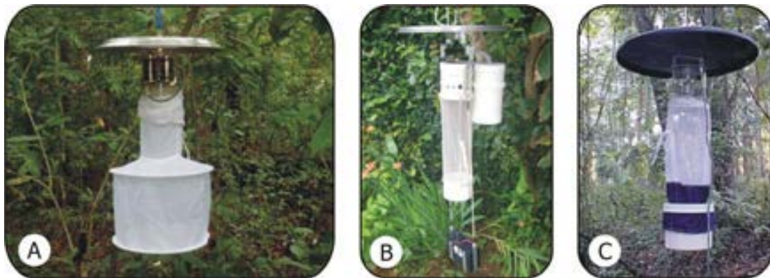
Figura 8. Armadilha CDC: A = modelo original; B-C = modelos atuais (modificados).
