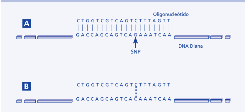
Figura 3. Hibridación específica de alelo. En A se observa un híbrido estable, totalmente apareado por sus bases, mientras que en B, el error de apareamiento entre C y C lo convierte en inestable [modificado de (12)].
