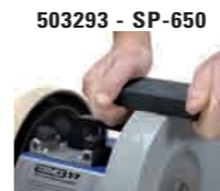
503293 - SP-650 Pietra in carburo di silicio per ravvivare la mola. Il lato più fine permette di portare la mola ad una grana 1000 mentre il lato con la grana più grossa riporta la mola alla granulometria originale. For changing the function of the grindstone. The fine side grades the stone for a 1000 grit finish. The coarse side of the grader reverses the stone to normal fast grinding.
