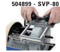
504899 - SVP-80 Dispositivo per l'affilatura dei ferri delle tupie con forature di 24, 30 o 38 mm. e con larghezza massima di 100 mm. For all shapes and makes of moulding knives with 24, 30 or 38 mm distance between guide holes. Max width of blades 100 mm (4").
