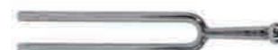
502518 Diapason 440Hz-La, lungh. 12cm e aste rettangolari - tuning fork 440HZ, length 12cm, square bar
