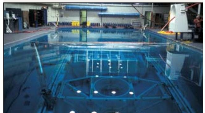
Figura 5. Piscina del laboratorio de simulación de microgravedad de la NASA, del Johnson Space Center, en Houston, Texas, Estados Unidos. Obsérvese la reproducción de la bodega de una lanzadera espacial en el fondo de la piscina, una compuerta de aeronave, equipos de buceo autónomo y un astronauta equipándose el traje espacial en los bordes de la piscina.
