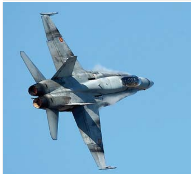
Figura 1. Avión F-18 del ejército español efectuando maniobras de demostración sobre el aeropuerto de Sabadell. Obsérvese el halo de condensación a ambos lados de la cabina.
