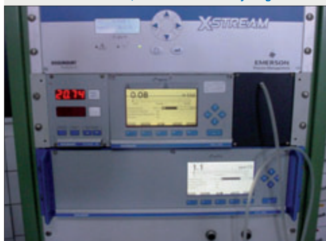
Figura 1. Equipo de análisis de gases: monóxido de carbono, dióxido de carbono y oxígeno.
