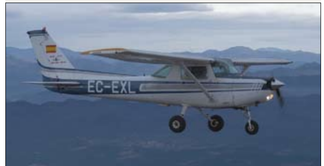
Figura 4. Avión monomotor de 2 plazas Cessna-152, muy popular para iniciación en aviación deportiva.
