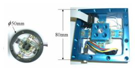
Fig. 10 3-Axis F/T Sensor
