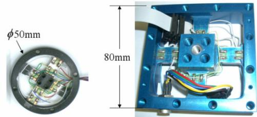
Fig. 10 3-Axis F/T Sensor
