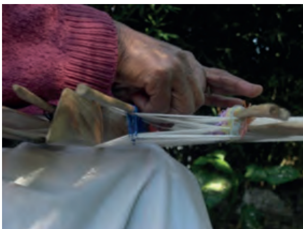
Se acomodan los hilos de urdimbre con ayuda de los machetes (tsotsopas): abren la calada de la urdimbre y separan las porciones ya tejidas de las que aún no lo son o que están en proceso de serlo, y con ayuda también de las varas de lizo (xioyo) cuyos bucles sujetan distintos hilos de la urdimbre.
