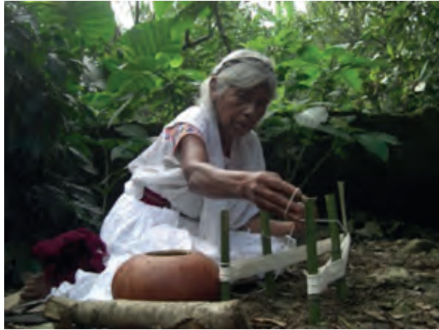
Antes de montar el telar de cintura, Juana Francisca Ramos urde el hilo en cinco estacas clavadas en la tierra. Fotografía: Carlos Heiras
