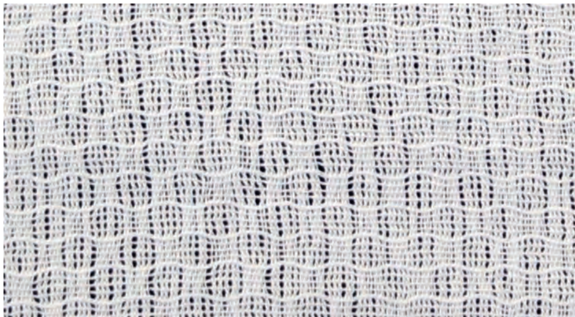
Gasa: ligamento abierto ixeuaiui
