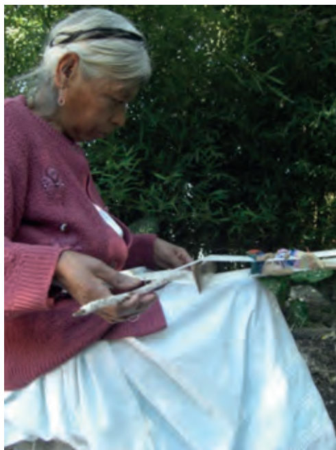
Se pasa la bobina (pakiyokuauit) con hilo de trama a través de la calada de la urdimbre que mantiene abierta con ayuda del machete.
