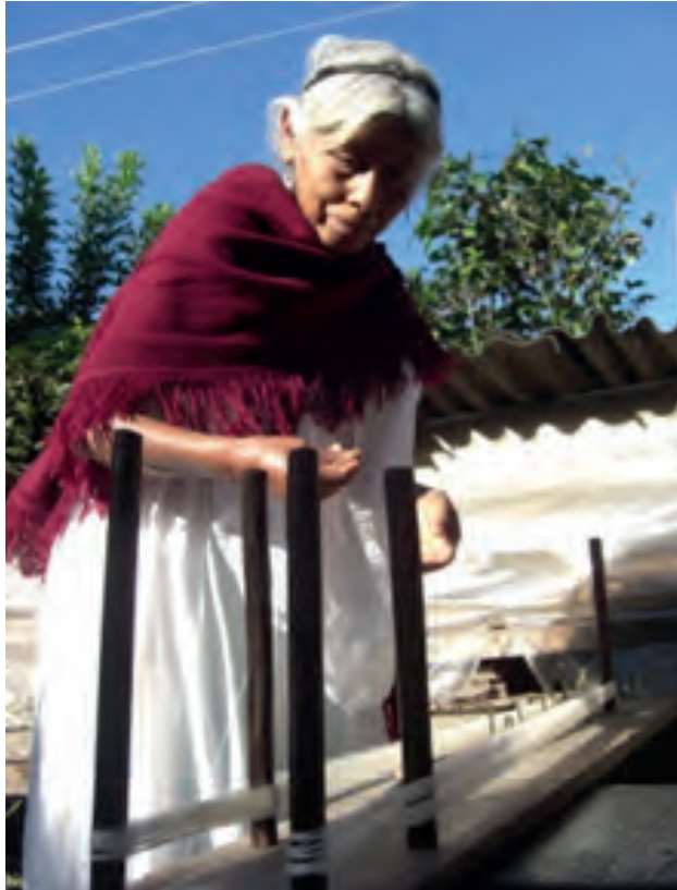
Antes de montar el telar de cintura, Juana Francisca Ramos urde el hilo en las cinco estacas de una tabla para urdir. Fotografía: Carlos Heiras
