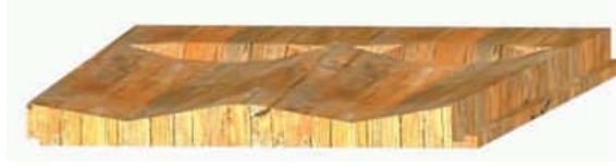
Figura 17 - 10: Tejuela con cortes superficiales.
