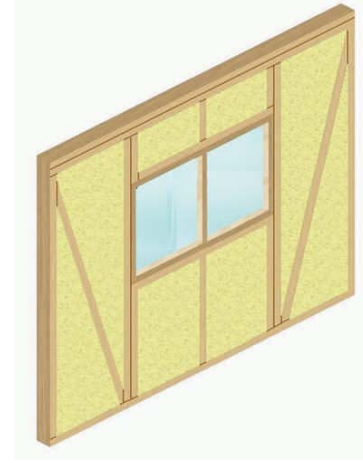
Figura 22 - 34: Colocar las ventanas mientras los tabiques se alzan.
