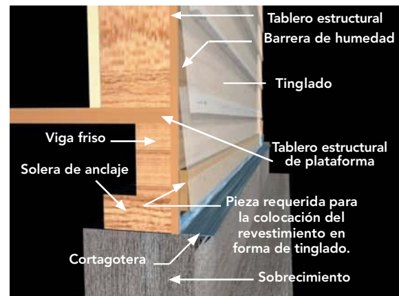
Figura 18 - 25: Inicio de la colocación del revestimiento, sobre la solera de anclaje con viga friso sobre fundación continua, con plataforma de madera en el primer piso.
