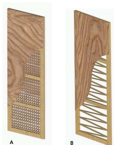
Figura 22 - 4: Diferentes almas de una hoja de puerta de placa. A) Virutas de madera en espiral B) Tablillas de madera dispuestas en forma de zig-zag.
