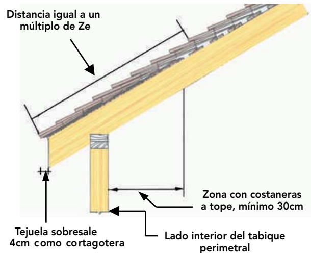
Figura 17-18: Corte que muestra las zonas y distancias mínimas de la techumbre a proteger de la humedad.
