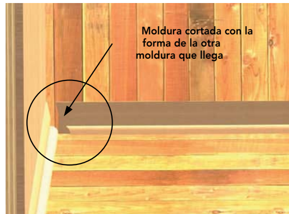
Figura 21-9: Vista que muestra el corte necesario a realizar en una de las molduras para obtener un calce perfecto entre ellas. Encuentro de esquina cóncava.
