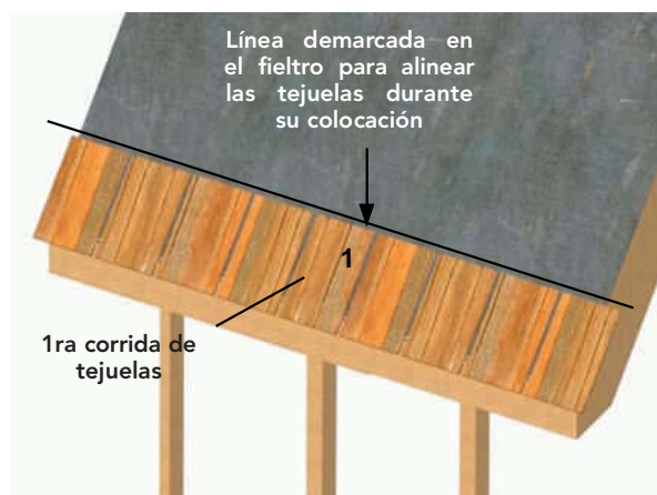
Figura 17 - 22: Para la colocación de la primera corrida de tejas se recomienda marcar el fieltro para que ésta quede alineada.
