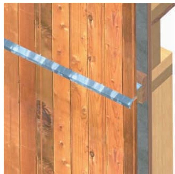
Vista en perspectiva del muro exterior con el revestimiento terminado y el cortagotera instalado
