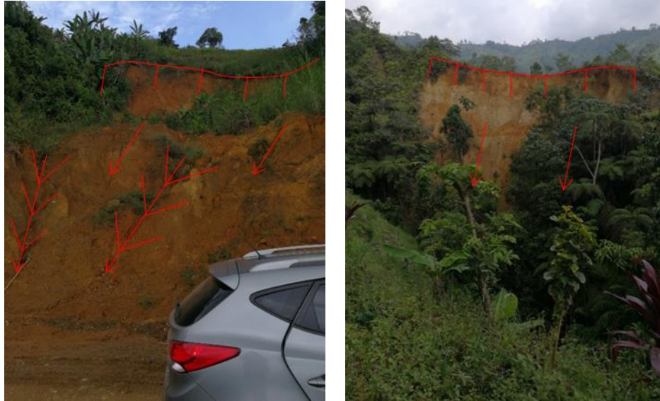
Foto 34. Deslizamientos rotacionales en suelo residual – Cuenca de la quebrada Calabazas
