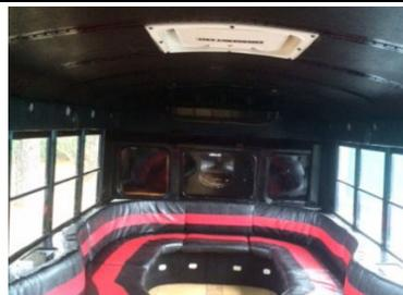
Este autobús escolar convertido ya no cumple con la Opción A del Método Dos debido a la eliminación de la puerta de salida trasera. Se ha agregado una escotilla en el techo para cumplir con el Método Uno.
