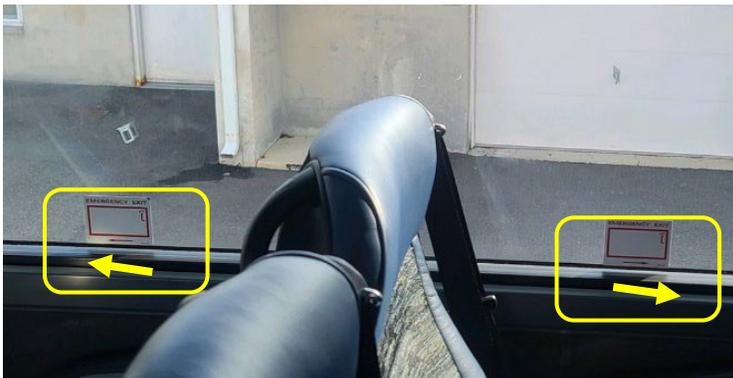
Estos rótulos, colocados en una ventana que no se abre, no diferencian claramente entre una salida de emergencia real y dónde pueda ubicarse una.
