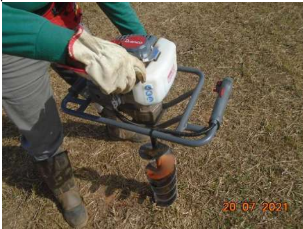
Foto 3 – Detalhe do perfurador de solo utilizado em campo.
