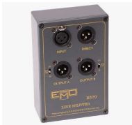
Line-Splitter EMO E370 1x In, 3x Out, mit Trafo
