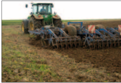
Abb. 12: Mit dem Grubber werden lediglich 10–15 cm gelockert.
