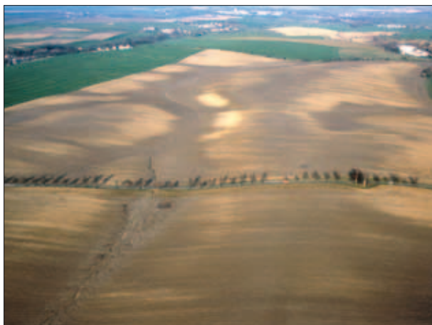
Abb. 4: Die Aufnahme zeigt eine charakteristische Abflussbahn mit hohen Erosionsschäden nach einem frühsommerlichen Starkregenereignis im Mittelsächsischen Lösshügelland.
