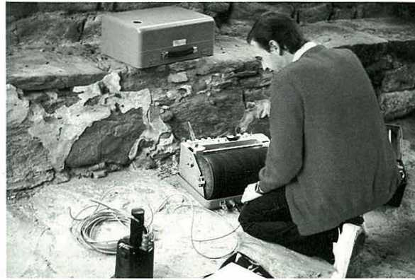
Un tècnic del servei Geològic de Catalunya, fent un registre sísmic al porxo de Sant Miquel del Corb.
