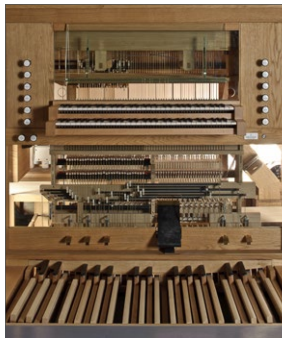
Abb. 19: Die Pfeifenorgel ist weitestgehend transparent, um die Funktionsweise der Mechanik sichtbar zu machen. (Fotos: Roman Wack, IBP)
