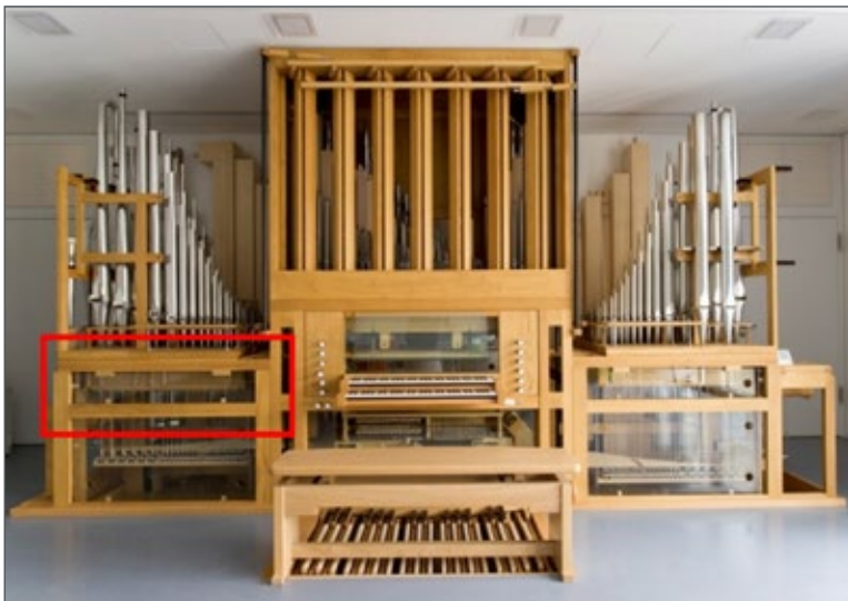
Abb. 18: Die Forschungsorgel des Fraunhofer IBP (gebaut 2011 von der Werkstätte für Orgelbau Mühleisen, Leonberg). Der rote Rahmen kennzeichnet die austauschbare Windlade. (Foto: Roman Wack, IBP)
