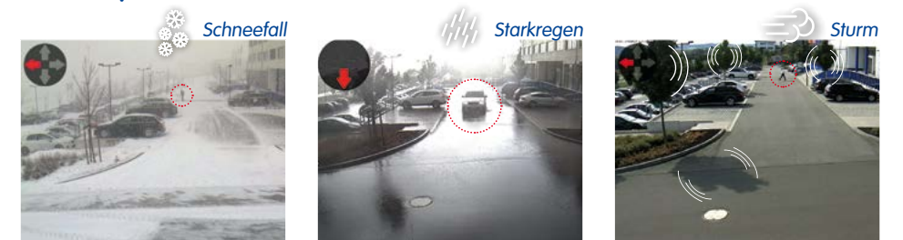
Sich im Wind wiegende Bäume, Wassertropfen auf dem Objektiv und Blitze werden ignoriert. Mit dieser weltweit einzigartigen, in die Kamera integrierten Technologie lassen sich Fehlalarme von Kameras in Außenbereichen um bis zu 90 % reduzieren.
