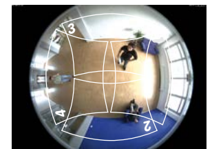
Vier virtuelle PTZ-Kameras aus einer einzigen 360° Hemispheric-Kamera
