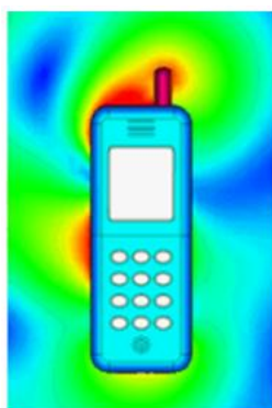
E-Nahfeld eines Mobiltelefons f = 2,1 \text{ GHz} ,
