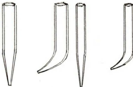
Bild 1. Injektionsrör i lämpligaste former, de grövre rören med en inre diameter av c:a 7 mm och de smalare med c:a 4,5 mm innermått.
