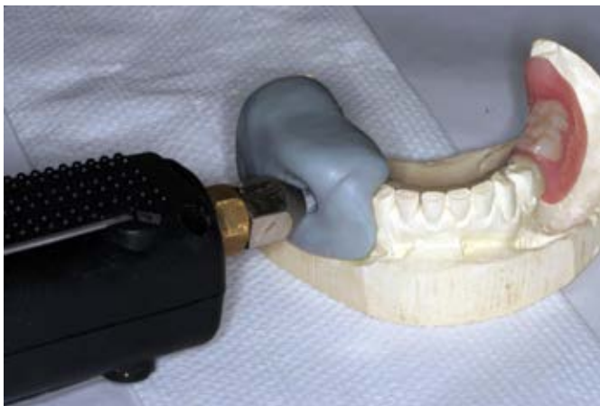
Figura 4: Inyectando resina acetálica caliente dentro de la matriz de silicona para formar el nuevo cuerpo.
