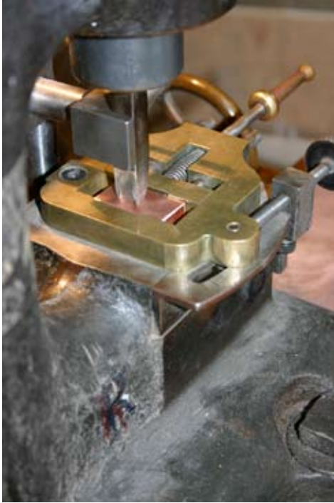
EINPRESSEN DER MATRIZE MIT DER BALANCIERPRESSE
