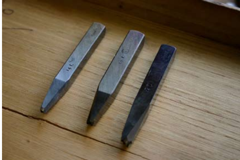
VERSCHIEDEN HÄRTEGRADE VON STEPELN, DIE ANHAND DER FARBE ERKENNBAR SIND
