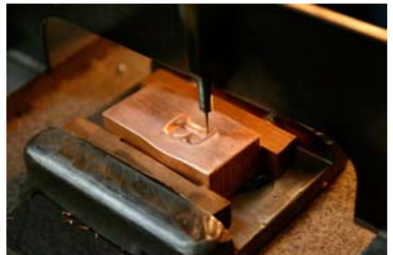
ZURICHTUNG DER MATRIZE PRÜFEN DER EINPRESSTIEFE
