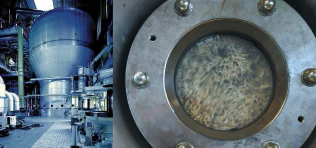
Auf besonders schonende Weise lassen sich die Zuckerrübenschnitzel mithilfe des Verdampfungstrockners (VDT) konservieren. Bei dieser neuen Technologie werden die Schnitzel im eigenen überhitzten Dampf bei ständiger Wirbelbewegung getrocknet. In den Dampfstrom gelangt kein Sauerstoff von außen, eine Verbrennung des Produkts ist also ausgeschlossen.
