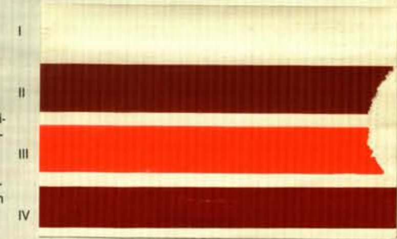
Farbbild 11.3: Farbflächen von einer weißen (I) und drei roten Proben: diffus (II), fluoreszierend (III) und retroreflektierend (IV)
